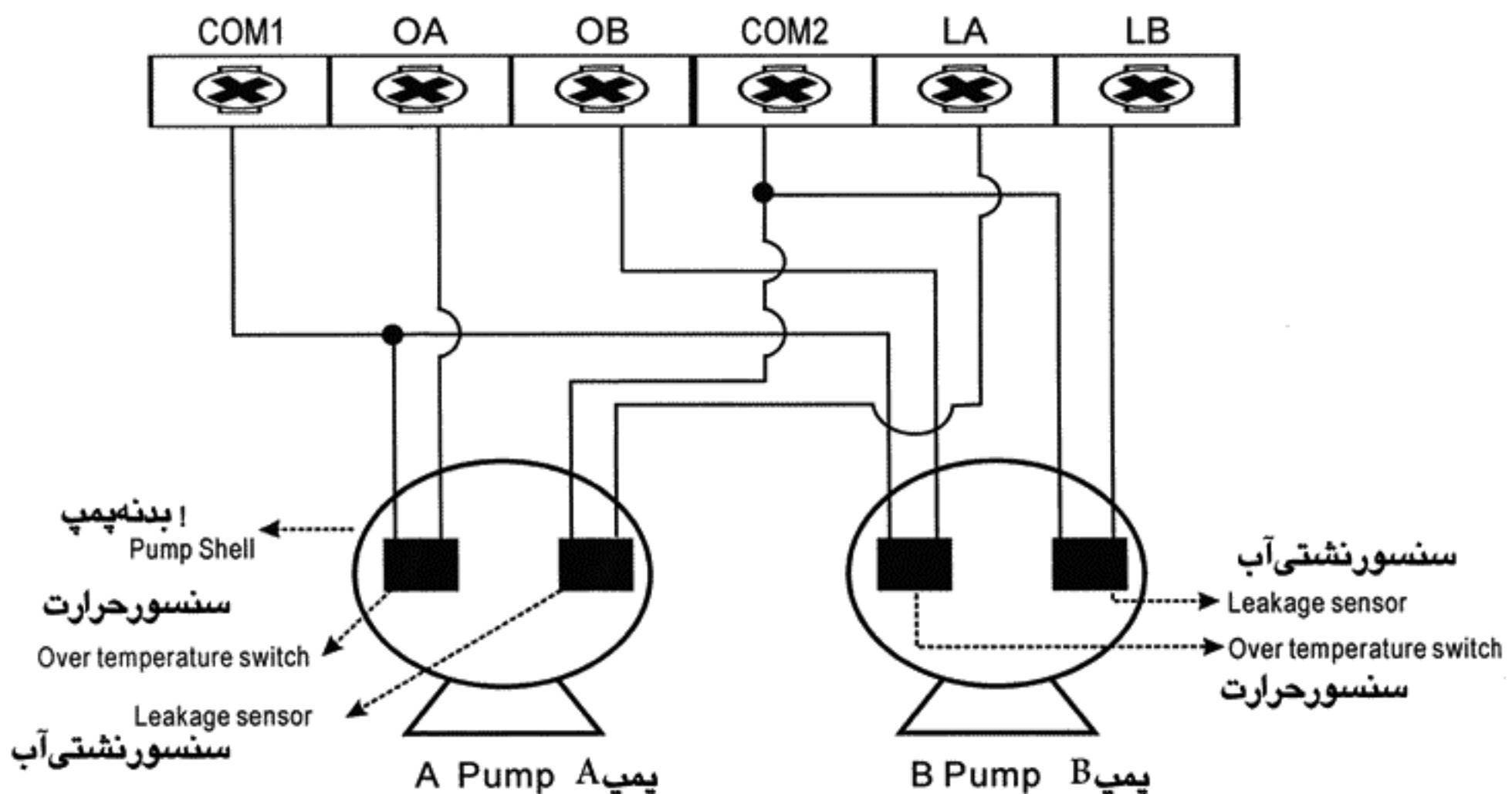
توجه: این دیاگرام برای پمپهای لجن کش مخصوصی می باشد که سنسورهای حرارتی و یا سنسور کنترل نشتی آب در آنها تعییه گردیده است.
