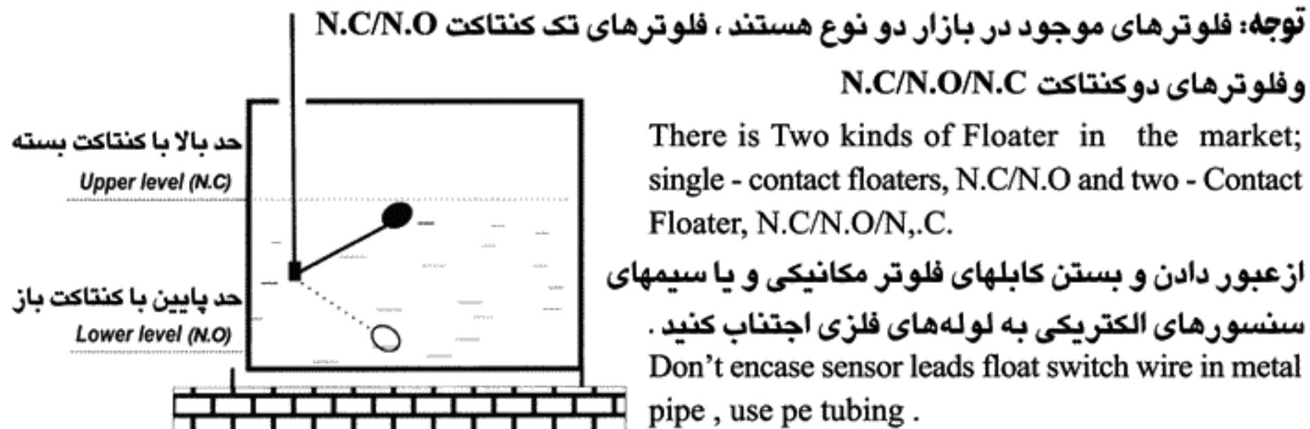
**توجه:** برای کنترل مخزن تخلیه شونده و یا پر شونده از فلوترهای تک کنتاکت استفاده شود. در صورت انتخاب فلوترهای دو کنتاکت با انتخاب سیمهای مناسب شرایطی مطابق فلوترهای تک کنتاکت را بوجود آورید. (گوی سمت بالا با شرایط کنتاکت بسته و گوی سمت پایین با شرایط کنتاکت باز)
