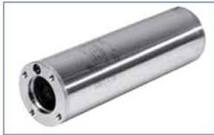
استاتور کپسول شده به همراه پوسته و فلنچ از جنس استنلس استیل **AISI 304L**. جهت تنظیم بهتر عملکرد دستگاه و انعطاف بیشتر استاتور، 24 شیار درون استاتور تعبیه شده است. دارای سیم مسی عایق بندی شده در کلاس **F** می باشد.
