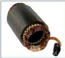
استاتور سیم پیچی شده به همراه پوسته ایاز جنس استنلس استیل **AISI 304 L** . جهت تنظیم بهتر عملکرد دستگاه و انعطاف بیشتر استاتور ، **24** شیار درون استاتور تعبیه شده است . دارای سیم مسی عایق بندی شده در کلاس **F** میباشد .
