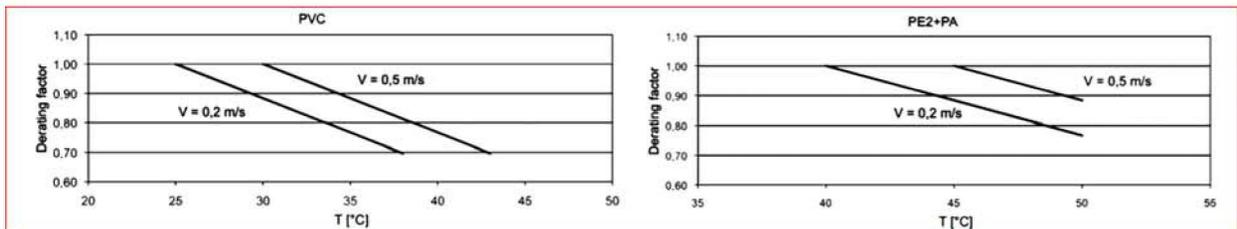
در موتورهای مدل **TR12220kw PE2+PA** و **250kw PE2+PA 50 Hz** و تمامی **TR12 60Hz**، حداکثر دمای سیال **10°C** پایین تر از مقدار دمای مندرج در جدول میباشد.
