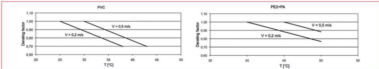
در موتورهای مدل **TR14 220kw PE2+PA** و **250kw PE2+PA 50 Hz** و تمامی **TR14 60Hz** ، حداکثر دمای سیال  $10^{\circ}\text{C}$  پایین تر از مقدار دمای مندرج در جدول میباشد .
