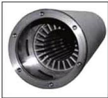
استاتور باسیم پیچی قابل تعمیر که در داخل پوسته ای از جنس استنلس استیل **AISI 316** قرار داده شده است . در مدل استاندارد ، سیم پیچی ها از جنس مس بوده و با **PVC** عایق بندی شده اند . در صورت درخواست و جهت کاربردهای خاص میتوانید از سیم پیچی های با عایق **PE2+PA** نیز استفاده نمایید .
