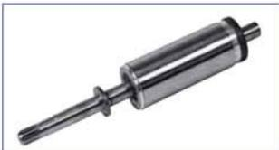
انتهای شفت از جنس استنلس استیل **AISI 304/Duplex** میباشد که طی فرآیند خاصی سطح آن میقل کاری و سخت شده و بوش ها نیز پولیش کاری شده اند. رتور قفس سنجابی که در موتورهای **3HP** از جنس آلومینیوم و در موتورهایی با قدرت بیش از **4HP** از جنس مس می باشد.
